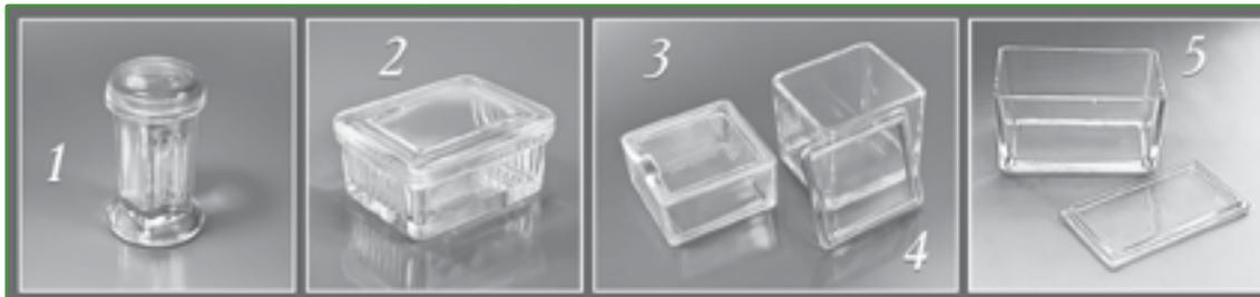
Предназначены для окрашивания микропрепаратов на предметных стеклах. Изготовлены из химико-лабораторного стекла. Индивидуальная упаковка.
