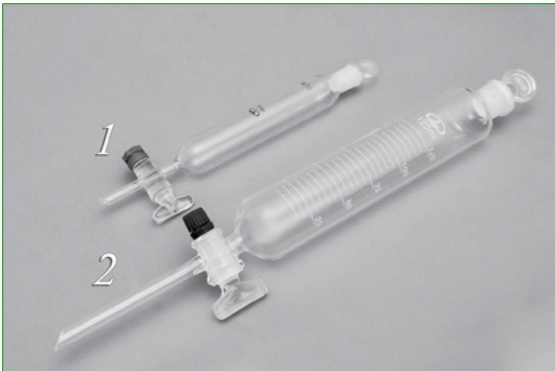
Предназначены для разделения несмешивающихся жидкостей в процедурах экстрагирования. Изготовлены из химико-лабораторного стекла по ГОСТ 21400-75, медицинского стекла по ГОСТ 19808-86.
