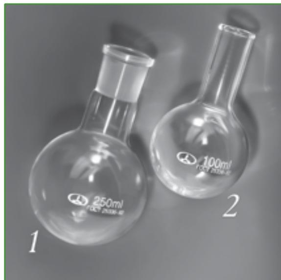
Разработаны для выпаривания, синтеза и других работ в лабораторных условиях. Изготовлены из химико-лабораторного стекла по ГОСТ 21400-75, медицинского стекла по ГОСТ 19808-86.
