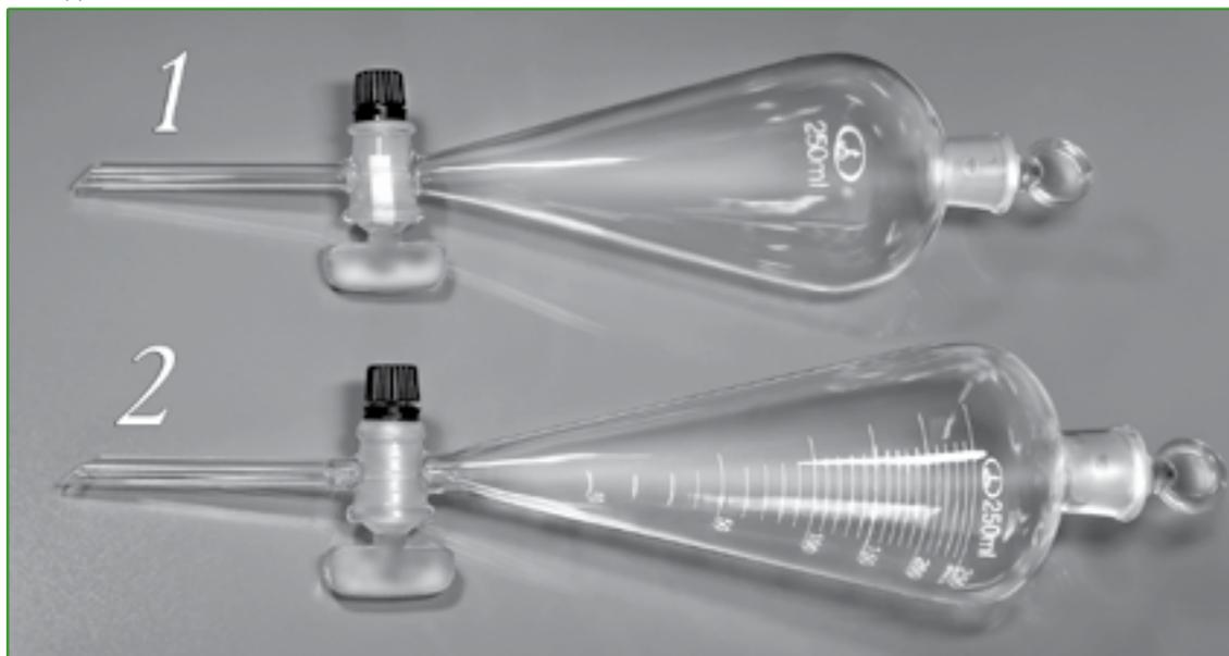
Предназначены для разделения несмешивающихся жидкостей в процедурах экстрагирования. Изготовлены из химико-лабораторного стекла по ГОСТ 21400-75, медицинского стекла по ГОСТ 19808-86.
