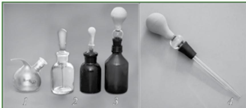
Предназначены для капельного дозирования различных растворов в лабораторной практике. Изготовлены из химико-лабораторного стекла по ГОСТ 21400-75, медицинского стекла по ГОСТ 19808-86.
