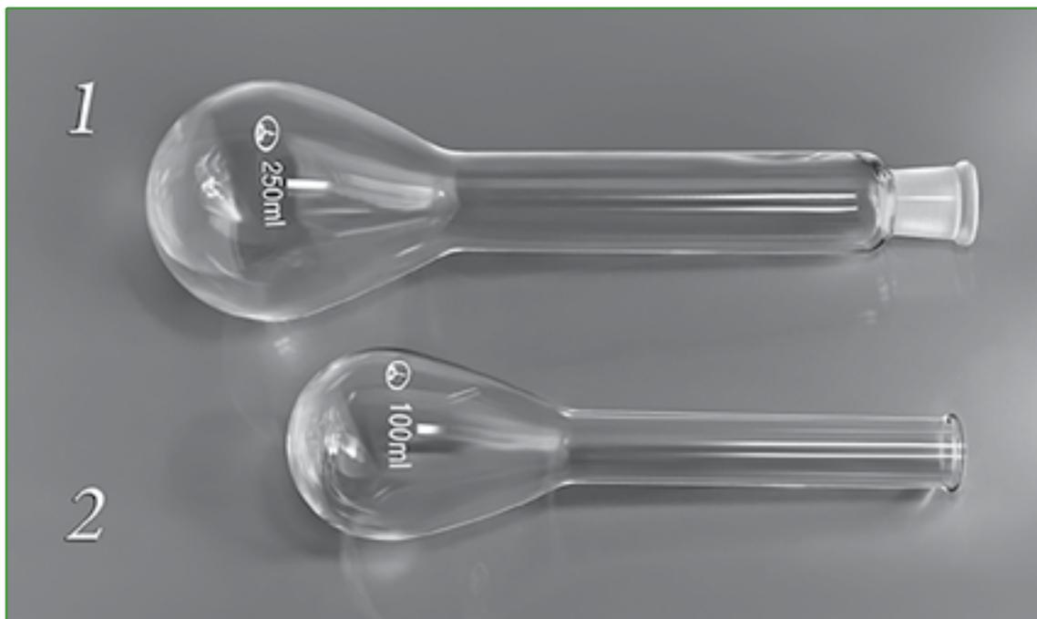
Используются в аппарате Кьельдаля, применяемом для определения азота. Изготовлены из химико-лабораторного стекла по ГОСТ 21400-75, медицинского стекла по ГОСТ 19808-86.
